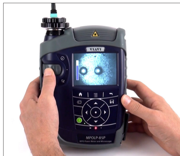
Inspección de conectores MPO con PCM integrado
