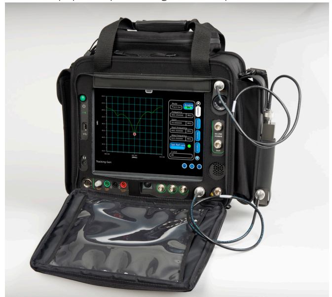
Sistema 8800SX dentro de la funda con el puente de pérdida por retorno conectado
